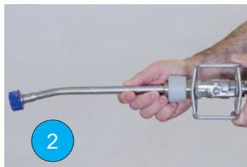
(DA) Kontroller at kugleventilen for enden af den blå forsyningslange er lukket. Ventilhåndtaget er vinkelret på slangen når den er i lukkeposition.
