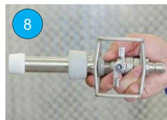
**SR** Da biste otvorili kuglični ventil okrenite dršku u smeru kretanja kazaljke na satu. Ventil je skroz otvoren kada je drška paralelna sa crevom.
