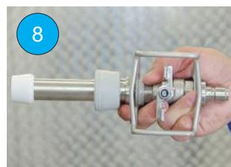
(DA) For at åbne kugleventilen drejes den forsigtigt mod uret. Ventilen er helt åben når håndtaget er parallel med slangen.
