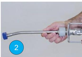
**SL** Zagotovite, da je krogelni ventil na koncu modre cevi zaprt. Ročaj ventila je v zaprtem položaju pravokoten na cev.
