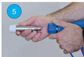
**SL** Potegnite nazaj manšeto ventila. Vstavite šobo. Sprostite manšeto ventila. Potegnite konec šobe, da zagotovite, da je šoba trdno pritrjena na krogelni ventil. Če ni, ponavljajte predhodni korak, dokler šoba ni trdno pritrjena na krogelni ventil.
