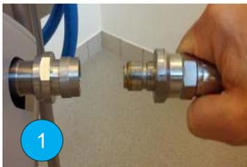
**SL** Povežite dovodno vodno cev z vhodnim nastavkom na strani enote. Dovodna vodna linija mora imeti nastavek s hitro spojko, ki se preprosto poveže z vhodnim nastavkom.
