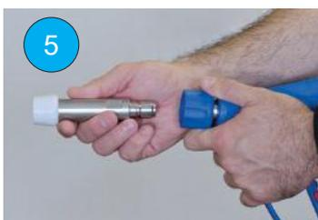
(DA) Træk ventilkoblingen tilbage. Isæt dysen. Frigør ventilkoblingen. Træk i enden af dysen for at sikre at dysen er korrekt tilsluttet til kugleventilen. Er dette ikke tilfældet gentages det foregående indtil dysen er korrekt tilsluttet kugleventilen.
