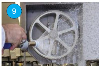
(LT) Užpurškinkite putų ir išskalaukite vandeniu arba sterilizavimo priemone.
